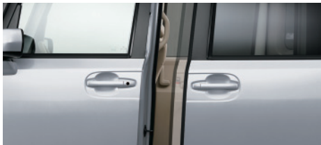
パワースライドドア(リア左側) (タッチセンサー/挟み込み防止機構付、リモコン&運転席スイッチ開閉式)
